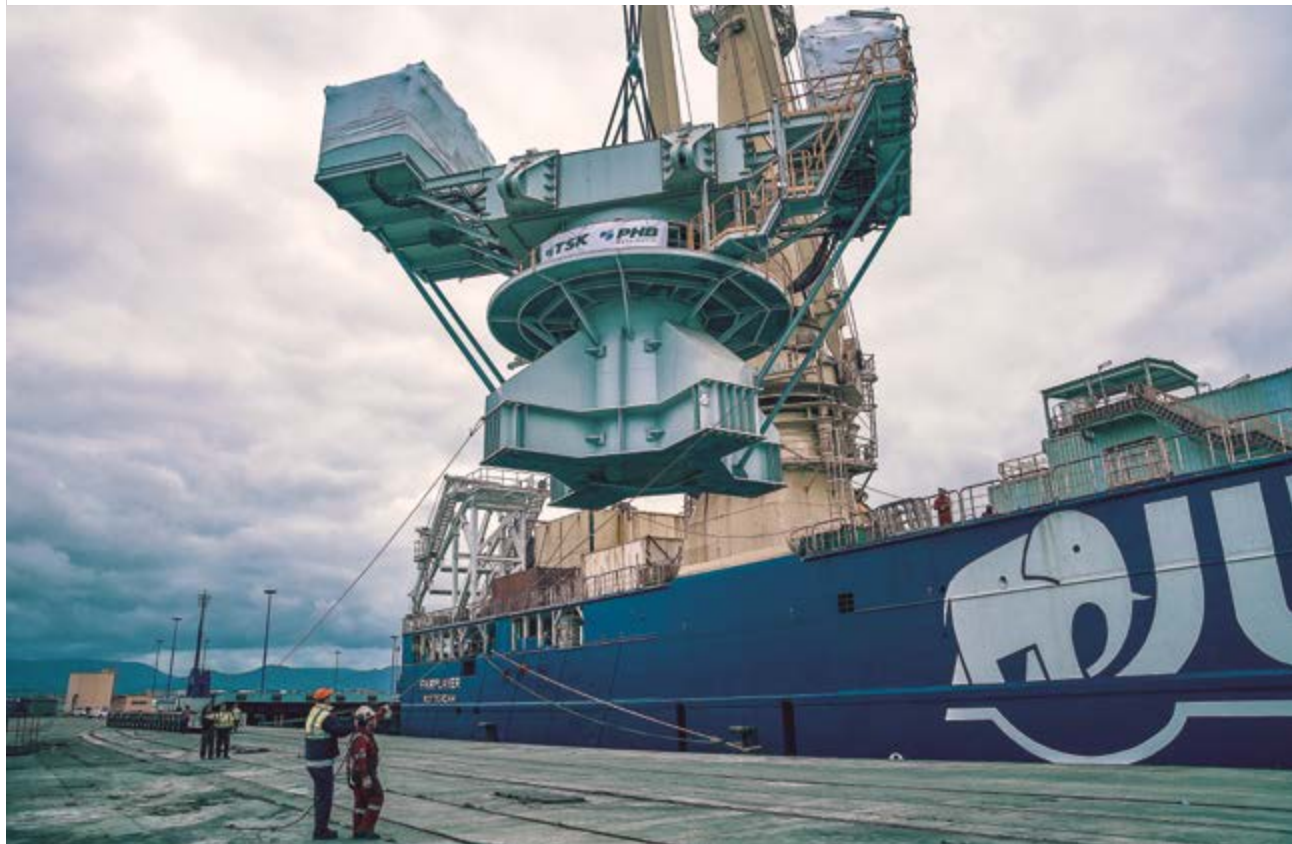
Cargador de buques de gran capacidad con brazo telescópico. FIRST QUANTUM MINERALS. Punta Rincón (Panamá)
